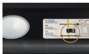
Der Magnetsensor prüft die magnetischen Eigenschaften des Sicherheitsfadens.
